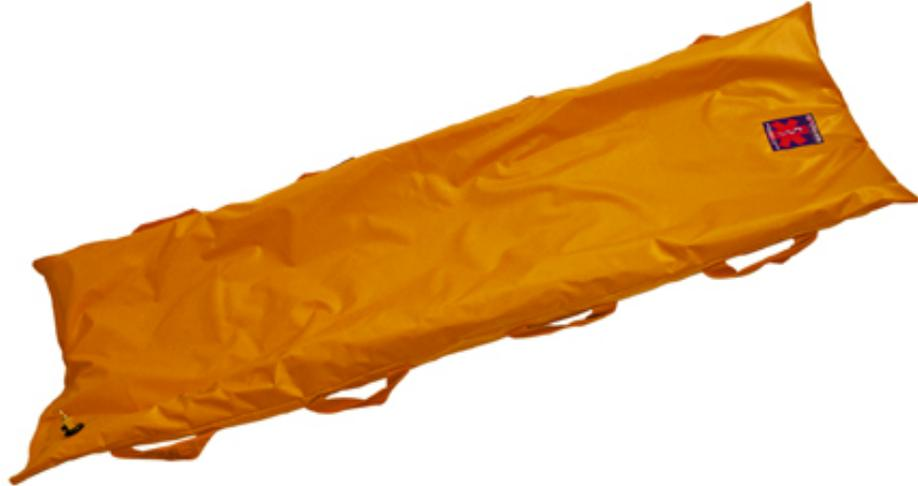
Il materasso è composto da due parti: la parte interna, realizzata saldando ad alta frequenza due robusti fogli di PVC senza soluzioni di continuità, contiene le sfere in polistirene; la parte esterna in nylon è dotata di otto maniglie che consentono il trasporto ed è protetta dalle abrasioni. La valvola on/off, realizzata in ottone cromato con portagomma incorporato, garantisce tenuta a qualunque temperatura e durata illimitata.
