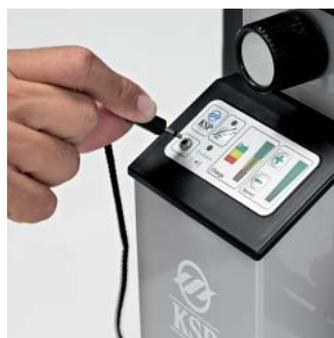
Jack di accensione/spegnimento. In caso di non utilizzo prolungato si attiva la funzione di Sleep-mode (stand by) segnalato da un allarme acustico. L'estrazione rapida del jack consente l'immediato arresto di emergenza della macchina in movimento.
