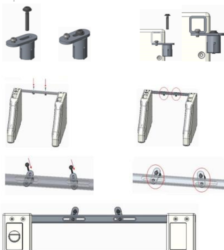
Figure 11 Fixer l'équipement avec les toilettes après avoir ajusté la distance par une pièce
