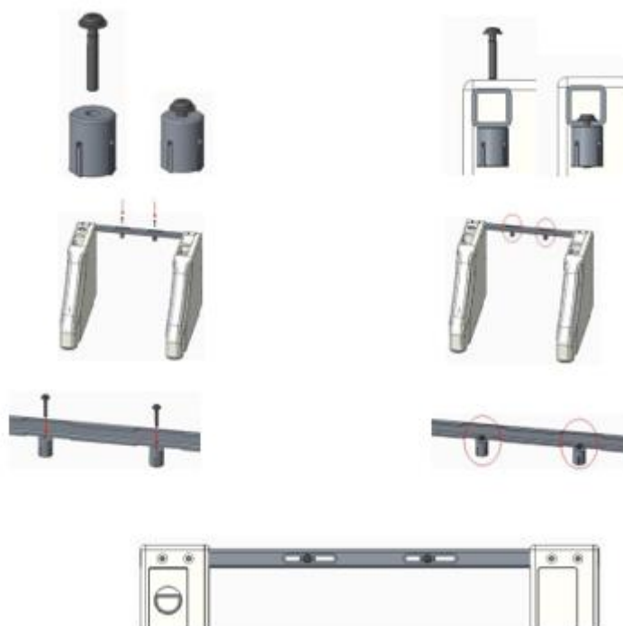
Figure 7.1 : L'équipement est fixé aux toilettes par des boulons
