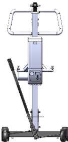
Leva a sinistra, base in massima apertura
