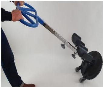
La maniglia deve essere inclinata di almeno 45° in modo che la piastra di base non tocchi il suolo quando il dispositivo viene spostato.
