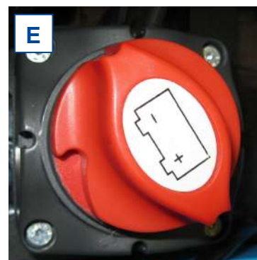
Posizione di fine corsa del sezionatore
