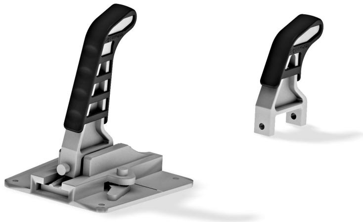
Bloccaggio posteriore del telaio della barella. E' realizzato in grafite vermiculare ad alta resistenza ed è composto da due elementi: una staffa che viene solidarizzata al piano di calpestio o al piano di carico e un elemento mobile che una volta bloccato garantisce il fissaggio della barella. Questa parte è rivestita in NBR per limitare il gioco con la barella stessa. Per garantire l'impiego con diversi modelli, viene fornito con l'elemento di ancoraggio con due diverse altezze.
