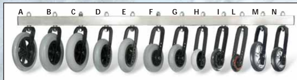
Ruotine anteriori: (A) piena stretta da 175 mm, (B) piena larga da 175 mm, (C) pneumatica da 175 mm, (D) piena da 150 mm, (E) pneumatica da 150 mm, (F) piena soft da 125 mm, (G) piena da 125 mm profilo arrotondato, (H) piena da 100 mm, (I) piena trasparente da 100 mm disponibile con e senza luci, (L) piena da 80 mm, disponibile anche in trasparente con luci, (M) piena da 125 mm cerchio in alluminio, (N) piena da 100 mm cerchio in alluminio. Front castors: (A) 175 mm narrow solid, (B) 175 mm wide solid, (C) 175 mm pneumatic, (D) 150 mm solid, (E) 150 mm pneumatic, (F) 125 mm soft solid, (G) 125 mm solid with rounded profile, (H) 100 mm solid, (I) 100 mm transparent solid available with or without lights, (L) 80 mm solid available also transparent with lights, (M) 125 mm solid with aluminium rim, (N) 100 mm solid with aluminium rim.
