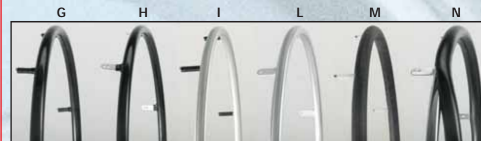
Corrimano: (A) Gommato Maxgrepp Ergo, (B) a timone, (C) in acciaio, (D) in titanio, (E) in alluminio con alette, (F) in alluminio con inserto avvitato, (G) gommato con inserto avvitato, (H) gommato con alette, (I) Tween Grepp con inserto avvitato, (L) Tween Grepp con alette, (M) Gommato Maxgrepp, (N) copricorrimano in silicone.
