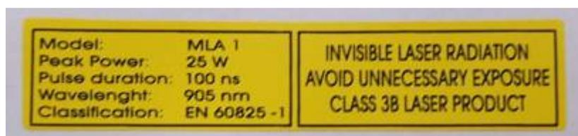
**Etichetta posta sul corpo del manipolo laser , riportante le caratteristiche**
